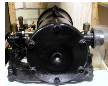
Likströmsmaskin Anno 1892. Dynamo Nr 299, Typ DU enligt Jonas Wenströms Patent. 110 V -8 A- 1700 rpm. Tillverkad den 3/11 1892 för Världsställningen i Chicago 1/5-15/11 1893.
